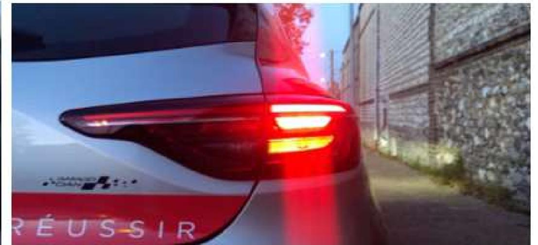
**Vérification des clignotants propres, en bon état de fonctionnement et pas cassés (toute anomalie et dysfonctionnement doit être signalé).**
