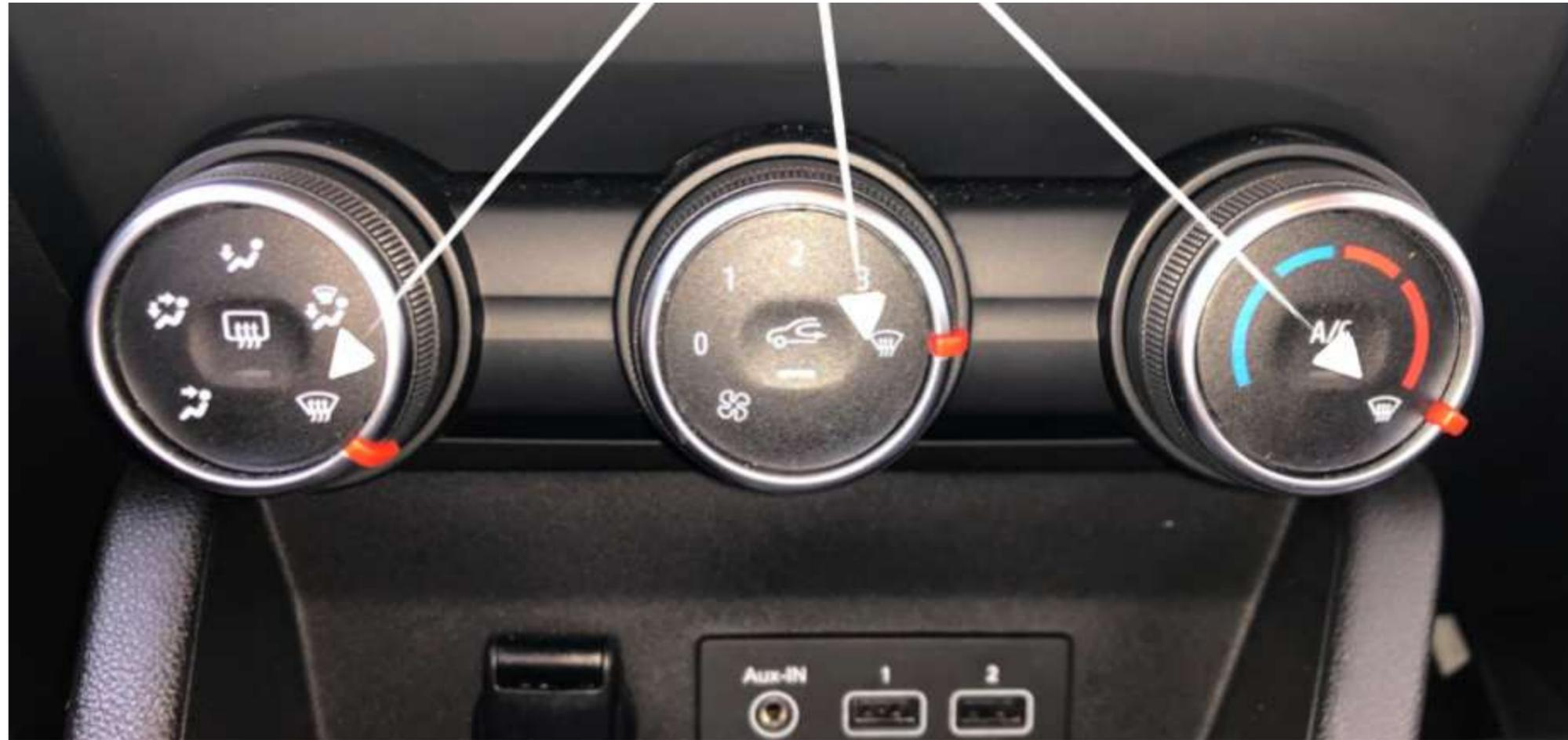
La position auto (désembuage automatique) peut être utilisée si le véhicule en est équipé
