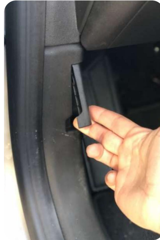
Sur le montant de la portière se situe une languette à tirer pour déverrouiller le capot du moteur
