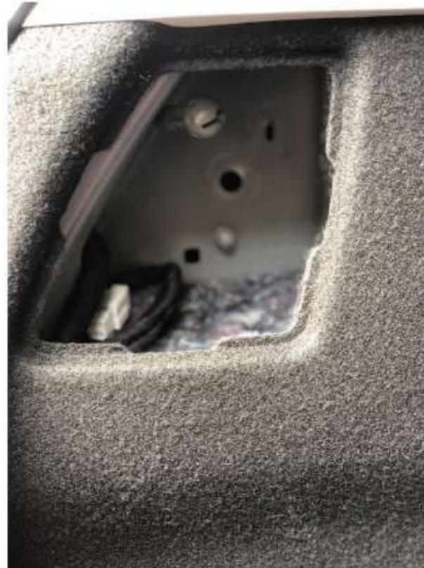
**Pour changer l'ampoule arrière, il faut se rendre dans le coffre, une trappe se situe à droite et à gauche.**
