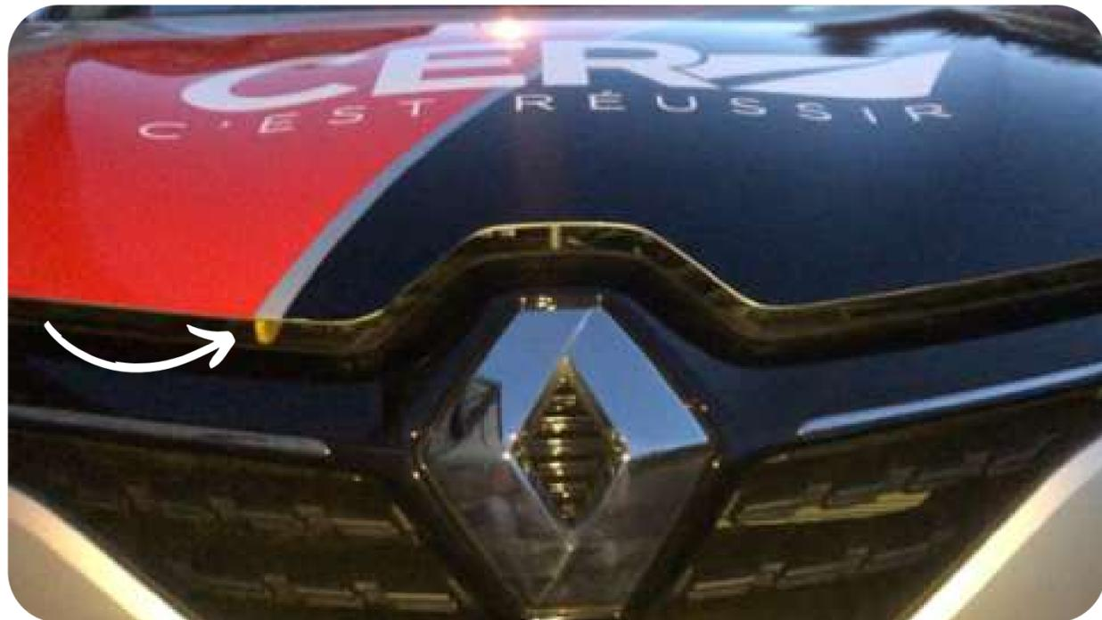
Une fois face au véhicule, un second verrou se situe sous le capot. Tirer la seconde languette vers la gauche pour déverrouiller le levier.
